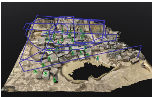
Рис. 2. Маршрут польоту БПЛА DJI Mavic 3 Enterprise під час реалізації UAV-знімання (ручний режим керування дрону)
