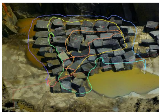
Рис. 3. Маршрут сканування на дослідному майданчику при застосуванні SLAM-сканера (Xgrid L1 / Alfageo R100)
