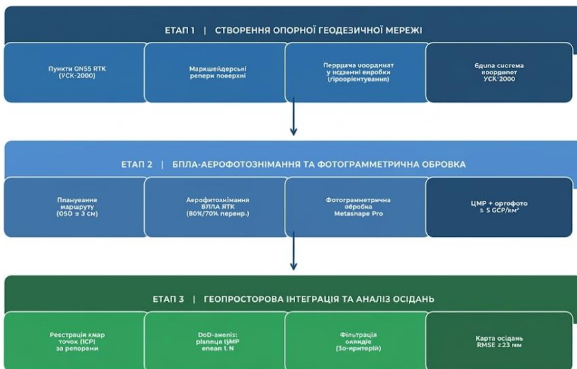
Рис. 1. Загальна схема інтеграції даних БПЛА-зйомки з підземним маркшейдерським моніторингом
