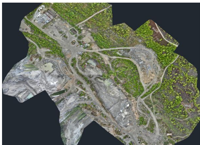
Рис. 6. Цифровий ортофотоплан в 3DSurvey
