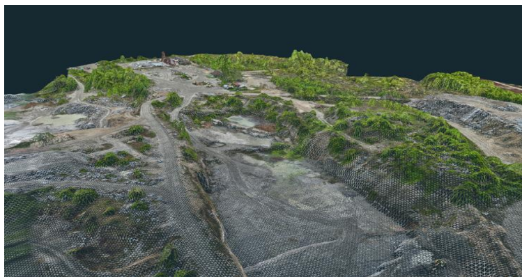
Рис. 5. Цифрова модель поверхні DSM в 3DSurvey
