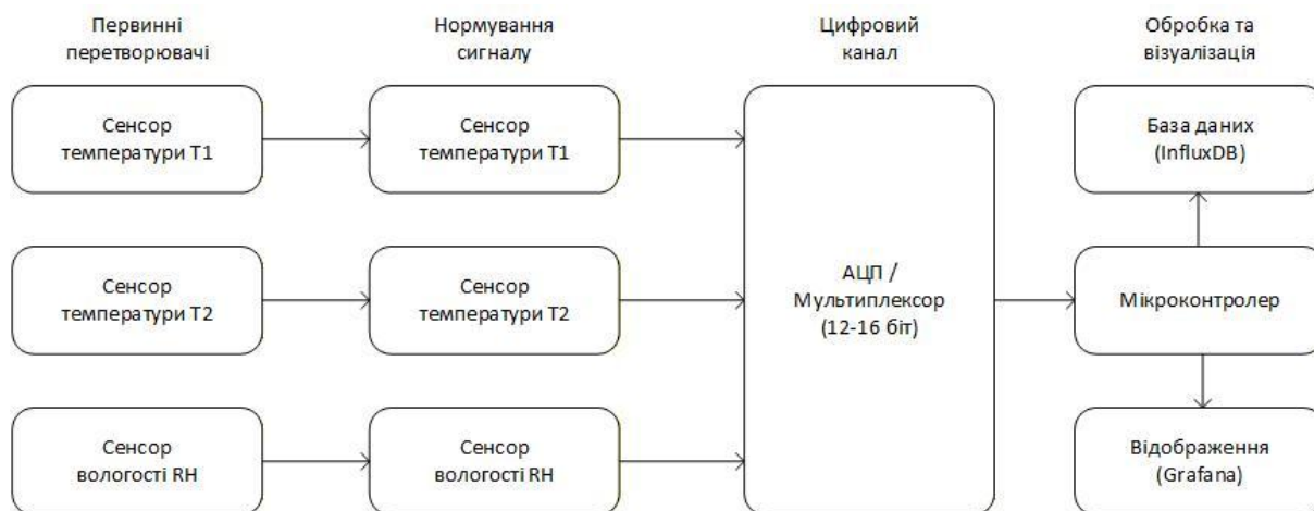
Рис. 1. Структурна схема інформаційно-вимірювальної системи контролю мікроклімату
