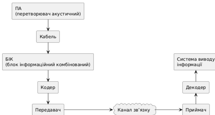
Рис. 1. Траса передавання інформації розподіленої інформаційно-вимірювальної системи механічних параметрів рідини в закритих резервуарах
