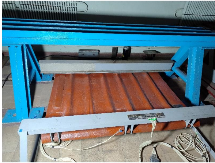
Рис. 6. Розміщення кришки люка на стенді
