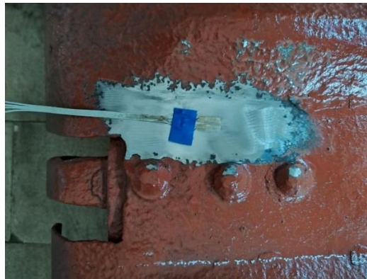
Рис. 4. Розміщення тензорезисторів на кришці люка
