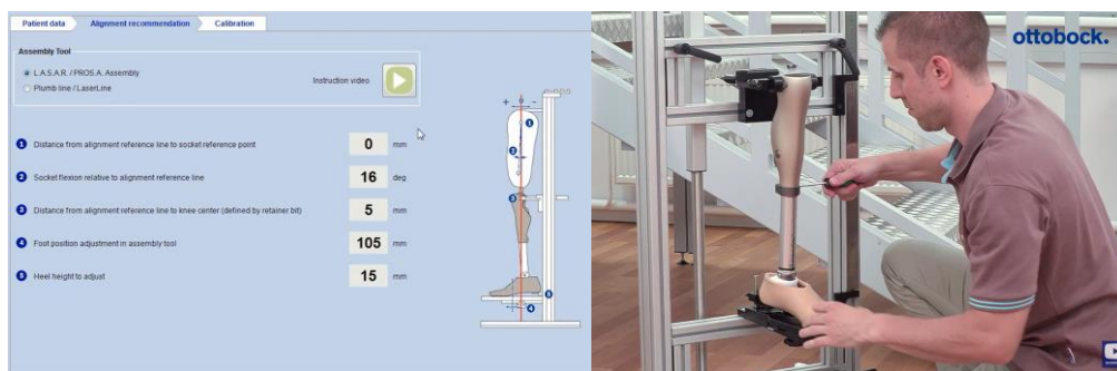
Рис. 2. Вимоги та монтаж трубчастого адаптера в модульному протезі [15]
