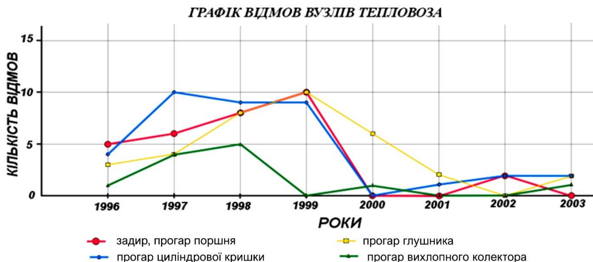
Рис. 6. Графік кількості відмов вузлів тепловозів (1996–1999 роки – до впровадження діагностичних карт, 2000–2003 роки – після їх впровадження)
