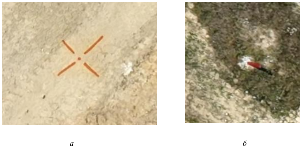
Рис. 2. Приклади закріплення GCP і зображення їх на знімках: а – тимчасові контрольні точки, б – постійні закріплені центри
