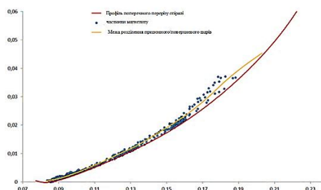
Рис. 9. Розподілення частинок магнетиту за висотою водного потоку на виході зі спірального сепаратора типу СВШ-2-1000
