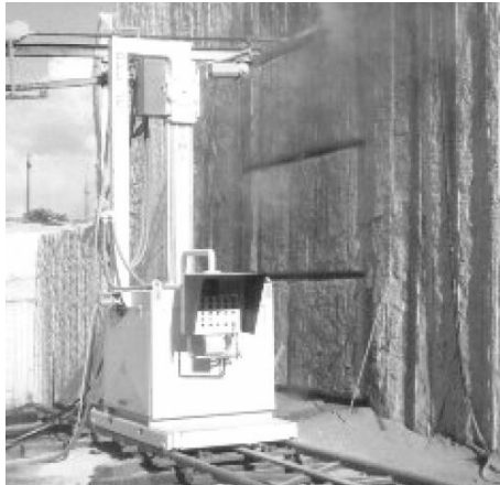
Рис. 2. Приклад використання машини гідроабразивного різання на гранітному кар'єрі в Сардинії (Італія) (R.Ciccu)[6]
