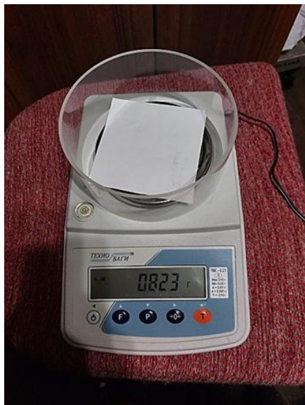
Рис. 4. Проходження імпульсного ультразвукового сигналу з частотою 40 кГц через папір для друку, обрахована поверхнева щільність паперу за амплітудою хвиль m_s = 86,6 \text{ г/м}^2 , а також визначення параметра руйнівним методом за допомогою вагів m_s = 82,3 \text{ г/м}^2
