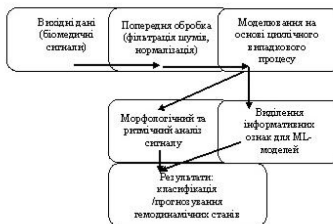
Рис. 3. Блок-схема моделювання гемодинамічного сигналу на основі ЦВП
