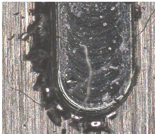
Рис. 5. Задирки при обробці сплаву NiTi фрезою діаметром 1 мм
