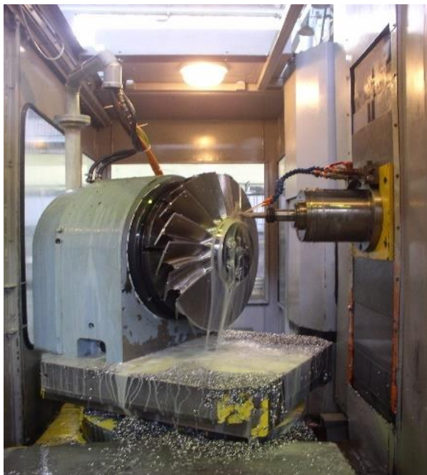
Рис. 3. Фрезерування колеса вентилятора на п'ятикоординатному обробному центрі
