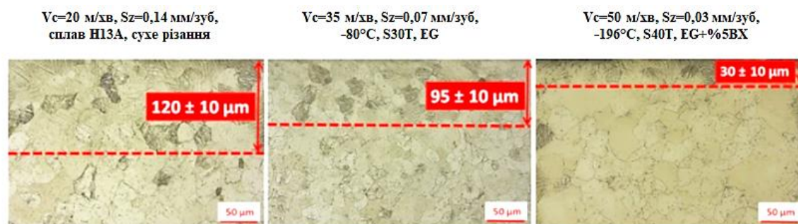
Рис. 6. Мікроструктура обробленої поверхні сплаву NiTi після торцевого фрезерування однозубим інструментом при різних умовах різання ( t = 0,7 мм) [6]:
