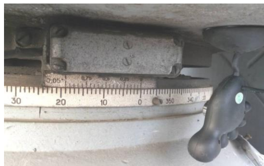
Рис. 2. Зображення азимутального лімбу опорно-повертального пристрою антенної системи та встановленої web-камери
