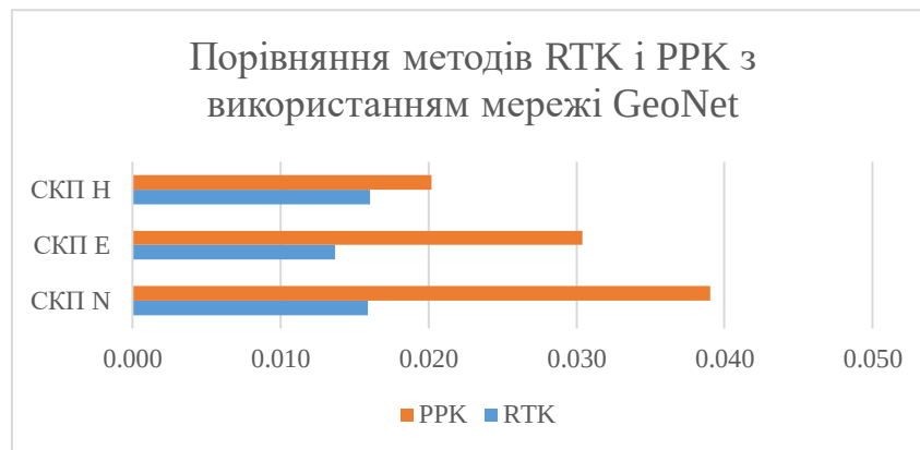
Рис. 4. СКП за координатами Northing (N), Easting (E) та Height (H) для всіх RTK-мереж
