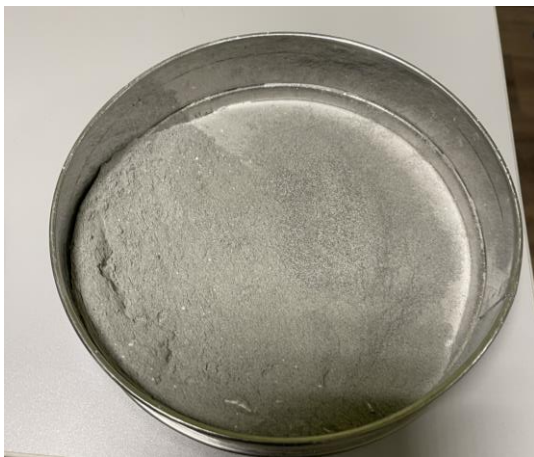
Рис. 3. Вигляд сит під час просіювання шламу
