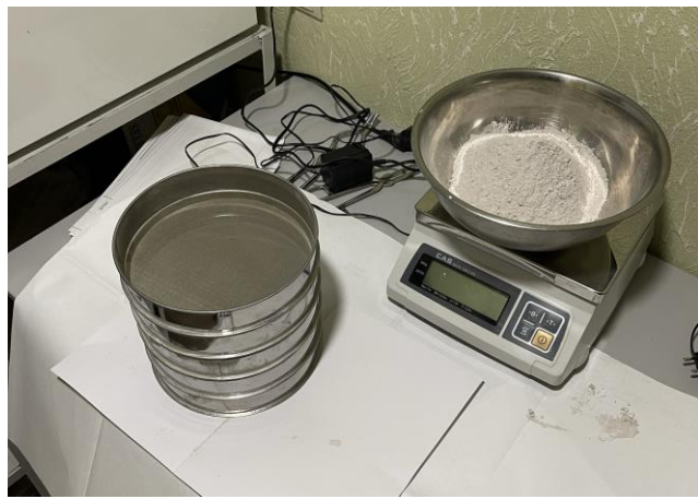
Рис. 3. Вигляд сит під час просіювання шламу
