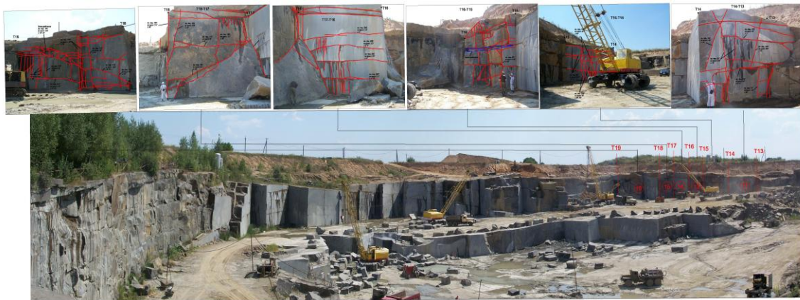
Рис. 1. Дослідження тріщинуватості габро Південної ділянки Бистріївського родовища
