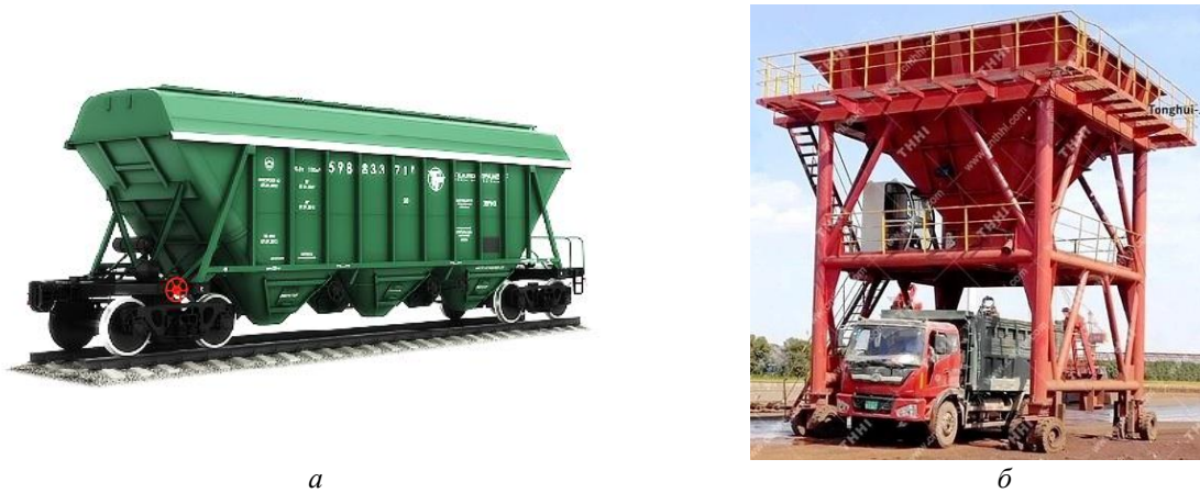
Рис. 3. Розвантажувачі-завантажувачі, що використовують при транспортуванні сипких матеріалів: а – хопер – саморозвантажуваний вагон бункерного типу; б – мобільний завантажувач-живильник «козлового типу»
