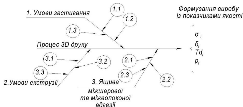
Рис. 6. Причинно-наслідкова діаграма обумовленості вихідних властивостей виробу режимами друку та динамікою використовуваного принтера
