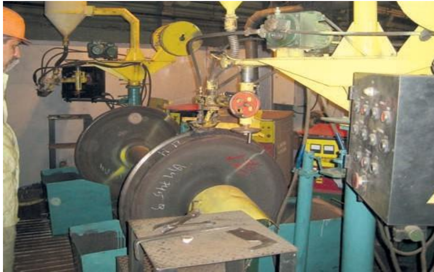
Рис. 3. Установа по наплавленню профілю кочення вагонних цільнокатаних коліс
