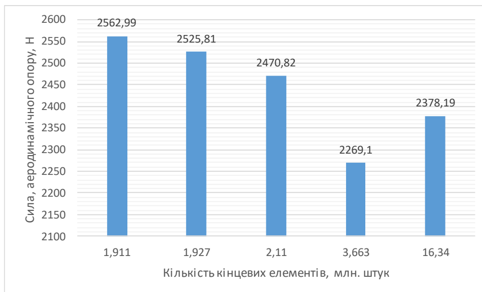
Рис. 3. Залежність сили опору від кількості елементів сітки
