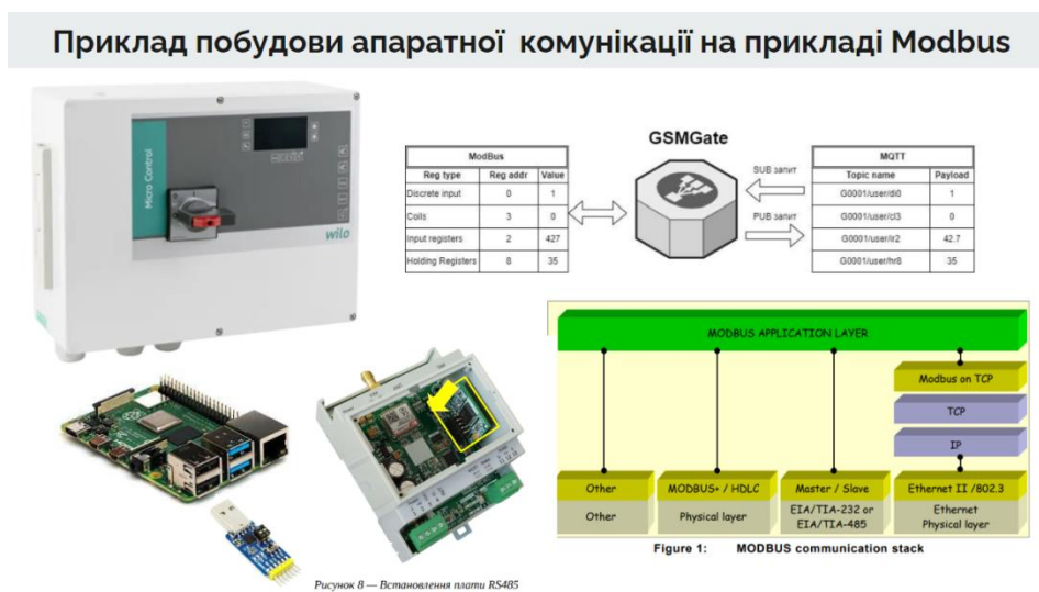
Рис. 6. Схема побудови інтеграції Modbus-пристрою з MQTT за допомогою Edge-пристрою
